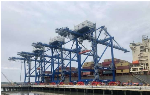
ベトナム・Phuoc An Port で稼働中の三井 E&S 製岸壁用コンテナクレーン (出典：株式会社三井 E&S HP)
